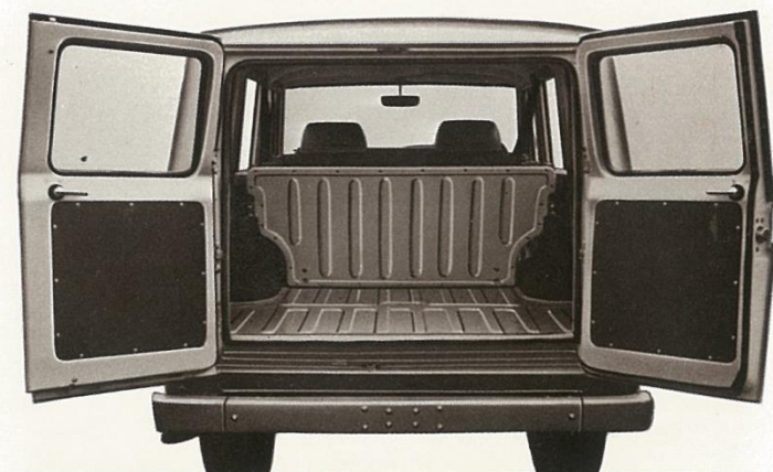
観音式リヤゲート…左右いっぱいに開きます リヤゲートはパワー式と観音式の2種用意。
