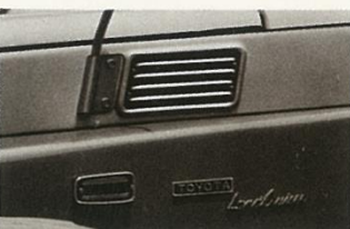
サイドターンシグナルランプ…確 認しやすく安全性の高い機構。
