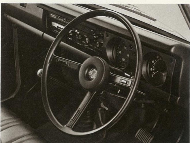
機能美にあふれた計器盤…厚いパッドで覆われたダッシュボード、 スイッチ類は識別のラクな絵表示式。運転は3段フロア式です。
