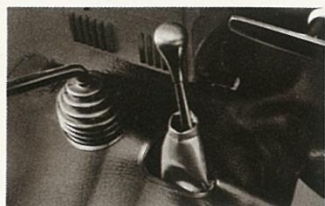
2スピード・トランスファー…3段 T M +2段T F で6段変速が可能。
