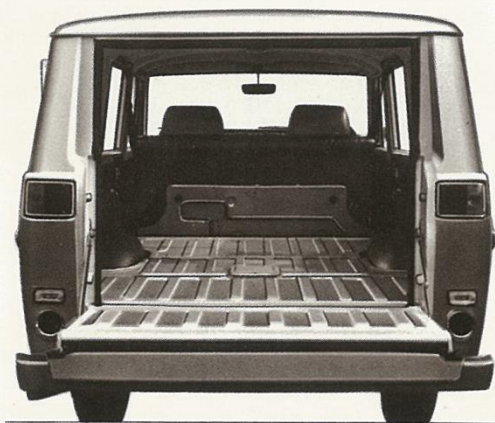
パワー式リヤゲート…リヤウィンドウは電動式 運転席から開閉をリモートコントロールできます。
