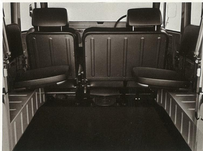
FJ40Vのリヤシート…左右に1人掛けのシートを配しています。荷室は床面がフラットで、積載性に優れた設計です。
