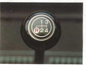
トランスミッション…フルシフトの4段ミッション。
