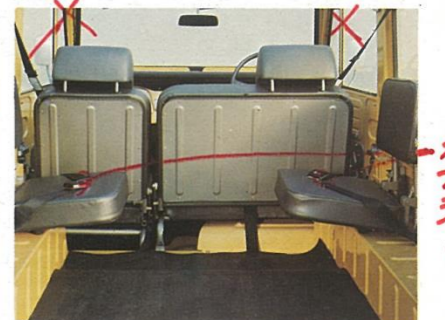
BJ40Vのラゲージルーム…長さ1,015mm×幅1,520mm×高さ1,205mmとなっぶり積み堅ろうな荷室。保温性もすぐれています。
