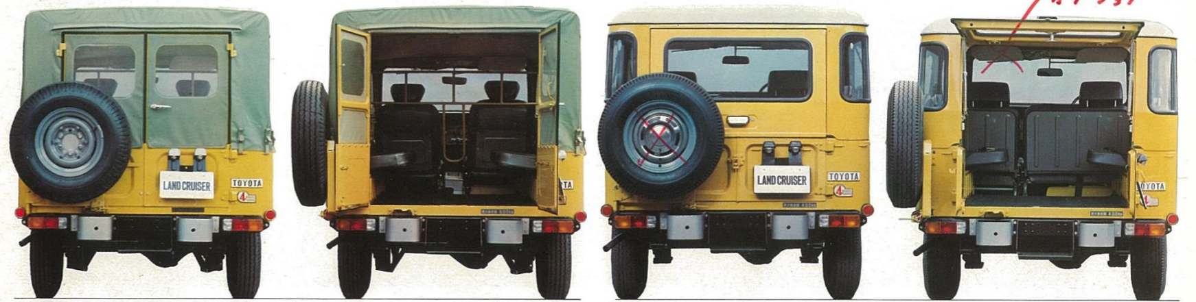
リヤゲート……BJ40系は観音扉と観音開きゲート+巻き上げ幌があります。(写真はBJ40-KC) リヤゲート……BJ40V系には、観音扉と観音開きゲート+はねあげ式ドアがあります。(写真はBJ40V-KB)
