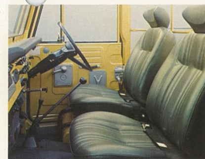
BJ40・43のフロントシート…ゆったりしたヘッドレスト付セパレートシート。3点式シートベルトも装備。
