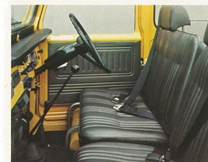
BJ40Vのフロントシート…小柄なボデーながら前席の余裕充分。ヘッドレスト付ベンチシート。3点式シートベルト装備。
