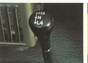
トランスファー…2段変速のトランスファーを標準装備。
