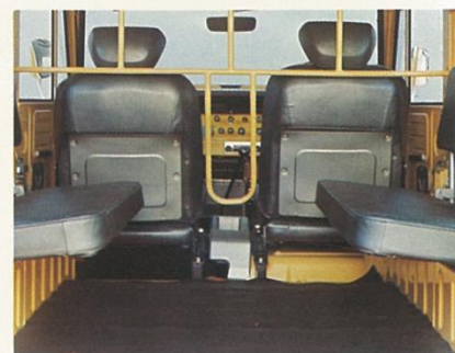
BJ40のラゲージルーム…合理的な荷室設計。2人乗りで400kg積。(幅510mm×高さ1,210mm×長さ1,200mm) BJ43…幅510mm×高さ1,210mm×長さ1,200mm
