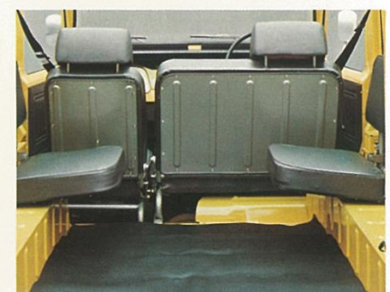
BJ40Vのラゲージルーム…長さ1,015mm×1,520mm×高さ1,205mmとたっぷり積み堅ろうな荷室。保温性もすぐれています。
