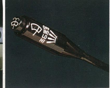
間欠ワイパー。大雨時のハイスピードに、雨の降りはじめや小雨のときに便利な間欠式をプラス。(G)
