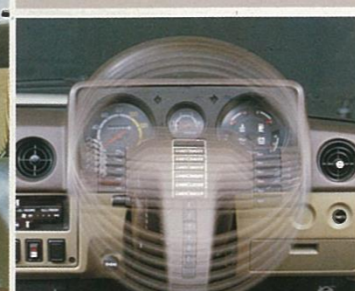
チルトハンドル。運転する人の体格にあわせて、ハンドルの高さを自由にセッティングできます。(G)
