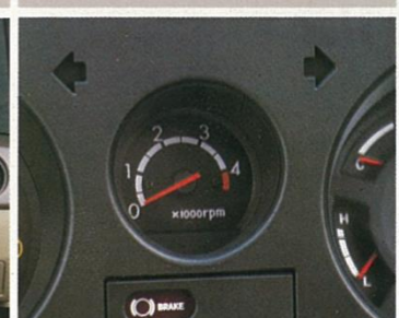
タコメーター。エンジン回転数を確かめながらのクラッチ、アクセルペダル操作でスポーツ走行も楽しめます。(G)
