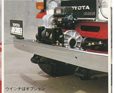
クロムメッキフロントバンパー。フロントマスクを際立たせるバンパー。グリルと同じクロムメッキ仕上。(L) 全車メッキグリル、リヤビジーヒットオプション
