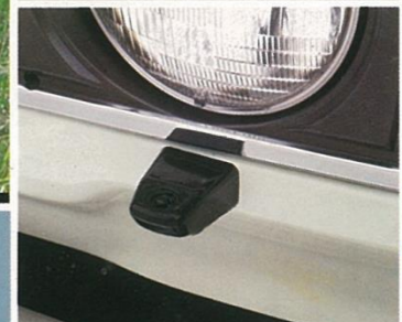
ヘッドランプクリーナー。夜間走行中に付着した泥水やゴミを、手元のスイッチ操作ひとつで洗い落とせます。(全車にオプション)
