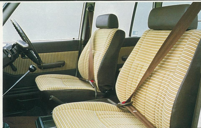
キャビン。豪華なカーペットを敷きつめた乗用車感覚のキャビン。ファブリック素材を採用したセパレートタイプのフロントシートはリクライニング機構をそなえ、スライド量も前後合わせて160mmになり、最適なドライビングポジションが自由に選ぶことができます。
