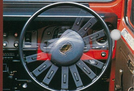
パワーステアリング キックバックが少なく、ハンドルを とれがちなラフロード走行や切り返しに便利。(LX標準)
