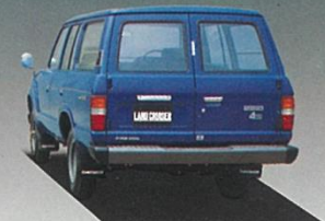
上下開き扉 荷室への荷物の出し入れがスムーズにでき、雨の日の作業にも便利。後方視界もすぐれています。
