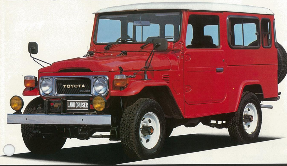
写真(BJ46V-MCM(W)(LX):2人乗り+350kg積、または5人乗り+200kg積 ●フリーホイールハブ、ハロゲンヘッドランプ、メッシュタイプフォグランプ、フルフロートリアアクスル&L.S.D.はオプション。
