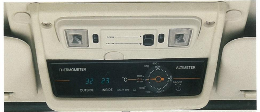
アクセサリメーター(60系VXに標準、GXにオプション) 室内外温度を示す温度計、高度計、スポットランプを見やすく一体化しました。(オーバーヘッドコンソール組み込み型)
