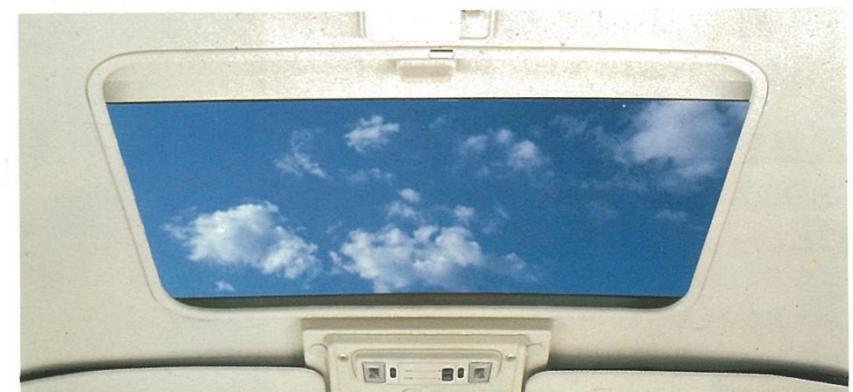
サンシェード付ムーンルーフ(60系ハイルーフ車に標準、写真はGX) 室内を光と風で満たす電動ムーンルーフ。閉作動時にスイッチを押し続けても、全開より100mm手前で一旦停止する安全装置付。
