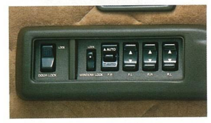
ワンタッチ式パワーウィンドウ&全ドアロックコントロール(60系VXに標準、GXにセットでオプション) 運転席から、すべてのドアの施錠、解除ウィンドウの開閉が集中操作できる、安全性と操作性に優れたシステム。
