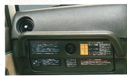
インパネアシストグリップ(60系全車に標準、写真はハイルーフVX) オフロードで威力を発揮するインパネアシストグリップを設定。発進時、停止時、そして旋回時にかかる体の揺れから助手席の人を守ります。
