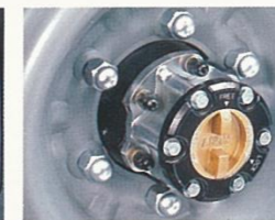
ワンタッチ2-4セレクター & メカニカルフリーホイールハブ (バンX-GXのパートタイム4WD、STDに標準)
