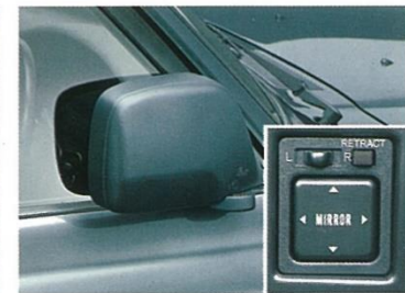
電動格納式ドアミラー(VX以上に標準、VXリミテッドはボデー同色)
