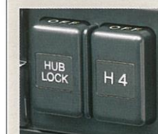
パワーロックングハブスイッチ(左)、ワンタッチ2-4セレクタースイッチ(右)
