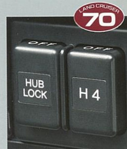
パワーロッキングハブスイッチ(左)、ワンタッチ2-4セレクタースイッチ(右) 写真はZX
