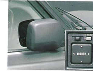
電動格納式ドアミラー(VX以上に標準、VXリミテッドはボデー同色)
