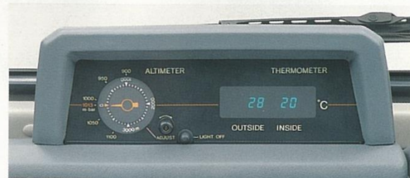
アクセサリメーター(高度計+温度計)(機タイプを除く全車にオプション)
