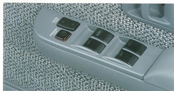
ワンタッチ式パワーウィンドウ&ドアキー連動パワードアロック (ZXに標準、LXにセットでオプション)
