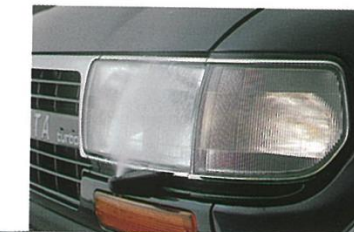
ヘッドランプクリーナー(VX以上に標準、GXにオプション)&コーナリングランプ(GX以上に標準)
