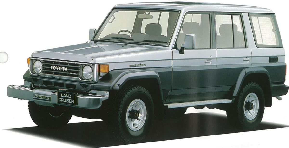
写真は70バン4ドアZX。フィールドランナー・トーンニング<28P>のボデーカラー、フルフロートリヤアクスル&電動デフロック(フロント・リヤ)、電動ウインチ、アクセサリメーターはオプション。
