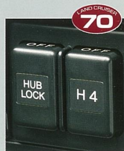
パワーロッキングハブスイッチ(左)、ワンタッチ2-4セクタースイッチ(右) 写真はZX
