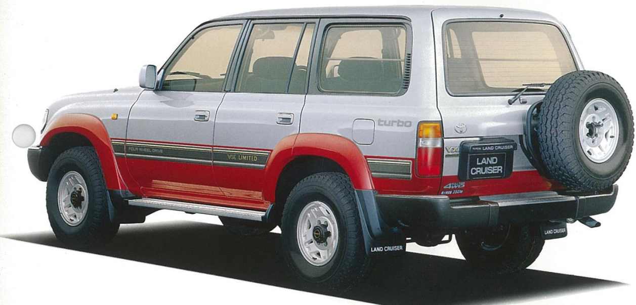
写真は80バンVXリミテッド。アドベンチャー・ロード・トローニング<20R>のボデーカラー、フルフロートリヤアクスル&電動デフロック(フロント・リヤ)はオプション。
