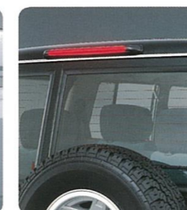
LED式ハイマウントストップランプ (ブラドEXワイド/ブラドSXワイド/ブラドSX) に標準、ブラドLXにオプション
