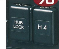
パワーロックングハブスイッチ(左)、 ワンタッチ2-4セレクタースイッチ(右) 写真はZX(LXIに標準)
