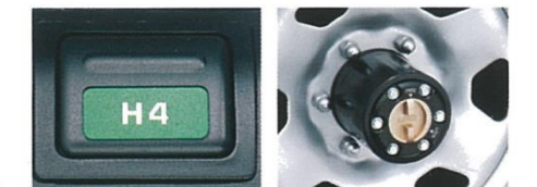
ワンタッチ2-4セレクター&メカニカルフリーホイールハブ (80バンVX、GXのパートタイム4WD、STDと70STDに標準) 写真は70系
