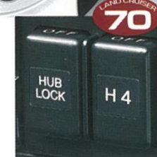
パワーロックングハブスイッチ(左)、 ワンタッチ2-4セレクタースイッチ(右) 写真は2X(LXに標準)
