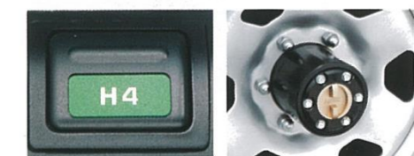
ワンタッチ2-4セレクター&メカニカルフリーホイールハブ (80バンVX、GXのパートタイム4WDと70STDに標準) 写真は70系
