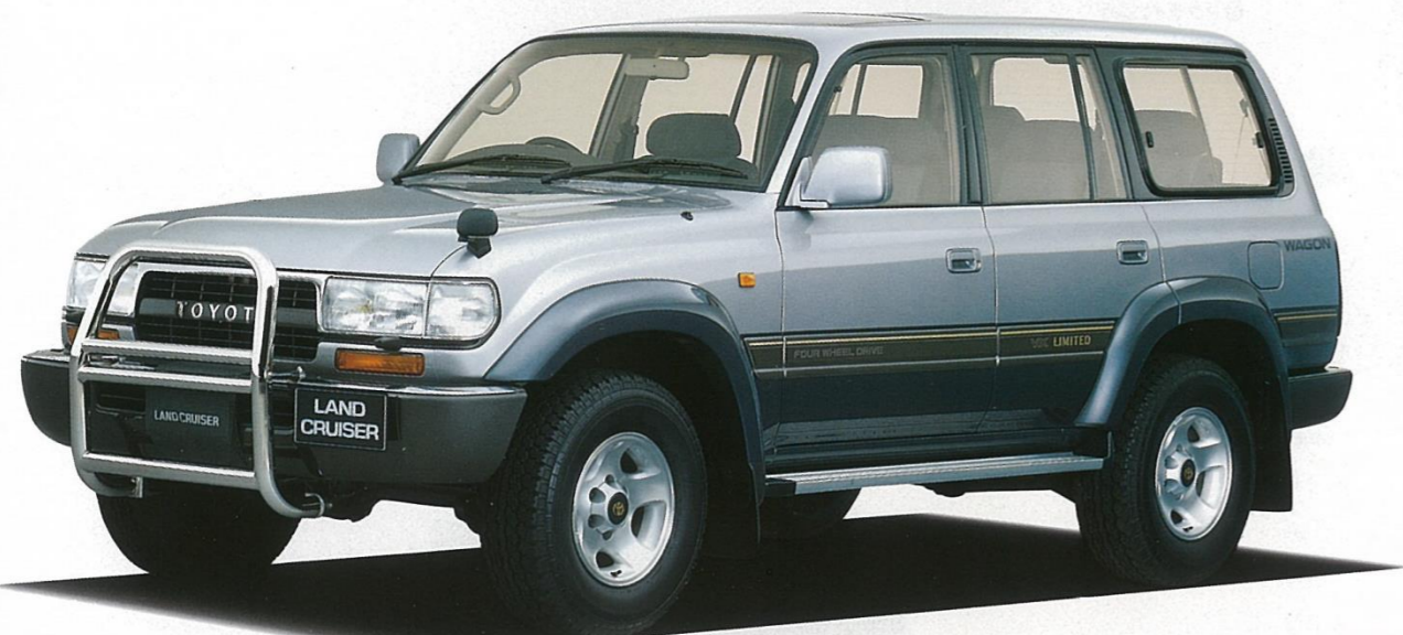
写真は80ワゴンVXリミテッド。フィールドランナー・トーンリング(26P)のボデーカラー、グリルガード、4輪ABS、フルフロートリヤアクスル&電動デフロック(フロント・リヤ)、電動ウインチはオプション。
