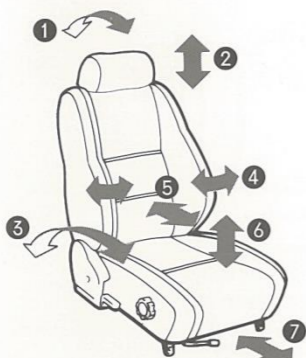
マルチアジャスタブルスポーツシート 1.ヘッドレスト前後調節 2.ヘッドレスト上下調節 3.リクライニング 4.サイドサポート 5.電動式ランバーサポート 6.シート上下アジャスター 7.シートスライド
