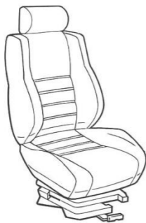
サスペンションシート 走行中の振動を効果的に吸収し、快適な乗り心地を実現する。乗る人の体重に合わせて、減衰力を調節できる。
