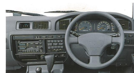
Photo: 80バンVXリミテッド 4200ディーゼルターボの室内。運転席SRSエアバッグ、ABS、電動デフロック(フロント&リヤ)はメーカーオプション、シートヒーター、フューエルヒーターは寒冷地仕様とセットでメーカーオプション。
