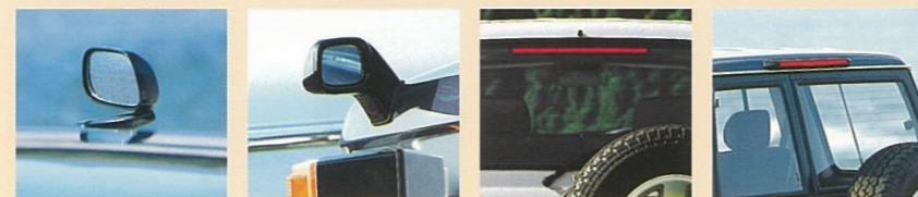
●補助確認装置(左:80用、右:70用) ●ハイマウントストップランプ(左:80用、右:70用)
