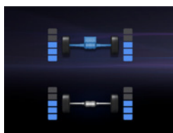
マルチインフォメーションディスプレイ内の前後輪トルク配分量表示
