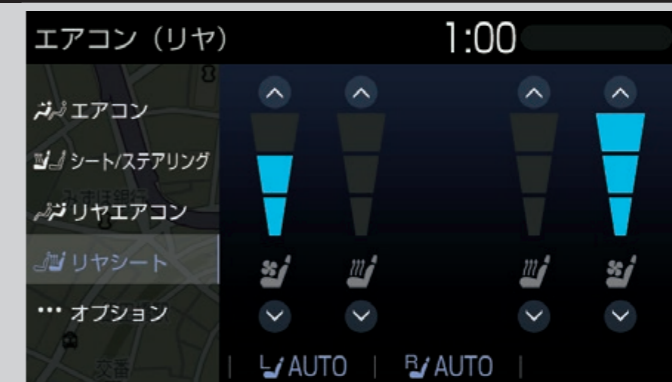
後左右席シートベンチレーション(メーカーオプション)/後左右席シートヒーター
