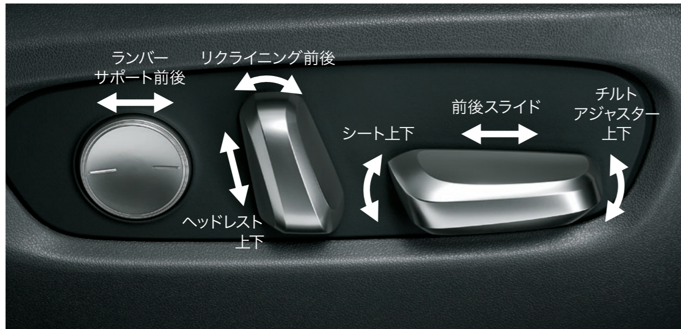
運転席10ウェイパワーシート(前後スライド・リクライニング・シート上下・チルトアジャスター・ヘッドレスト上下調整・メモリー機能付)+パワーランバーサポート
