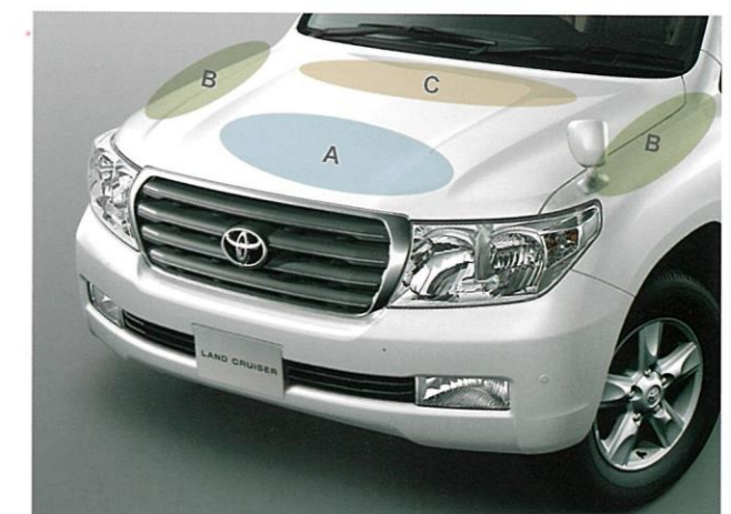
歩行者傷害軽減ボディ構造 A: フード部 B: フェンダー部 C: カウル部
