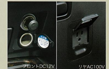
アクセサリソケット&コンセント *AC100Vは、100W以下の電気製品をご使用ください。 ただし、100W以下の電気製品でも正常に作動しない場合がありますので、詳しくは販売店におたずねください。
