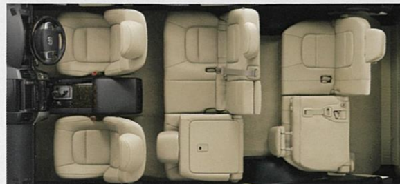
セカンドシートバック左側前倒し+サードシートバック左側前倒し状態
