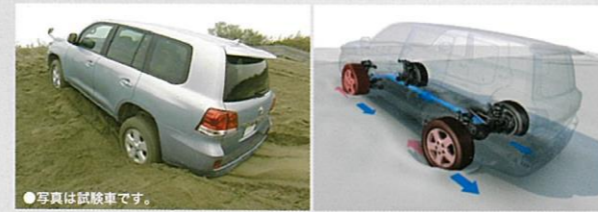
クロールコントロールシステムイメージ (スタック状態からの後退脱出)
