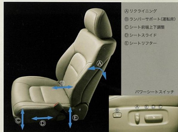
8WAYパワーシート(フロントシート)&電動ランバーサポート(運転席) 【8WAYパワーシートはAX"Gセレクション"に標準装備】
