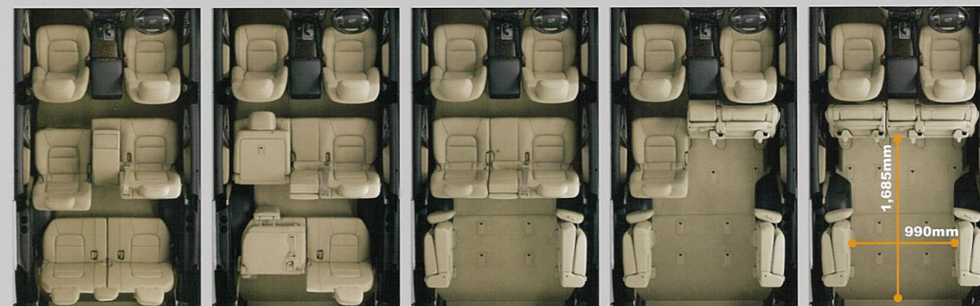
セカンドシート左側スライド+セカンドアームレスト使用状態 セカンドシートバック左側前倒し+サードシートバック左側前倒し状態 サードシートスペースアップ状態 セカンドシート右側タンブル+サードシートスペースアップ状態 セカンドシートタンブル+サードシートスペースアップ状態
