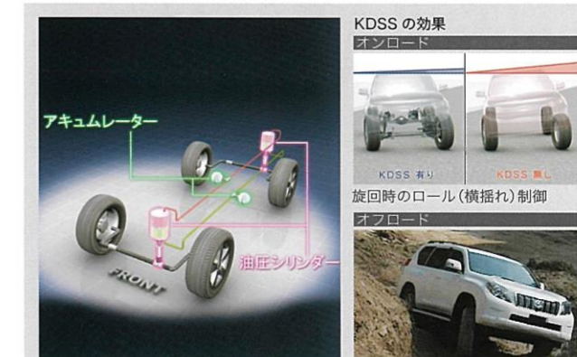
KDSSの効果 オンロード KDSSあり KDSSなし 旋回時のロール(横揺れ)制御 オフロード フラット感、走破性向上 ※写真は機能説明のためのイメージであり、市販の仕様とは異なります。
