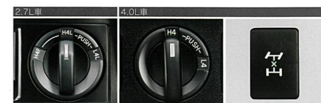
ダイヤル式トランスファー切替スイッチ センターデフロックスイッチ
