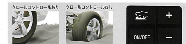
クロールコントロールあり クロールコントロールなし ホイールスピンやロックを抑制し、脱出をアシスト ホイールスピンしやすい クロールコントロールスイッチ ※写真は機能説明のためのイメージであり、市販の仕様とは異なります。
