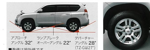
アプローチアングル 32° ランプブレークオーバーアングル 22° デパーチャーアングル 28° (TZ-Gは27°) ■数値は設計値です。 対地障害角 265/60R18タイヤ+18x7½Jアルミホール
