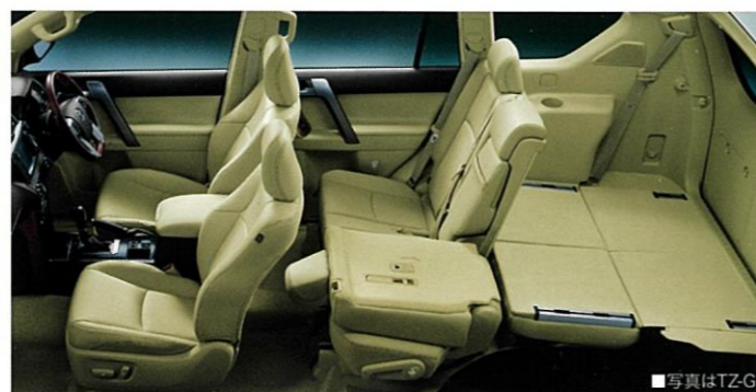
セカンドシート片側前倒し+サイドシート両側フロア格納状態
