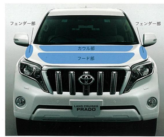
歩行者傷害軽減に配慮したボディ構造
