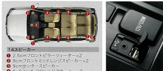
14スピーカー ① 2.5cmフロントツイーター×2 ② 9cmフロントミッドレンジスピーカー×2 ③ 9cmセンタースピーカー ④ 6x9インチ フロントドアウーハー×2 ⑤ 2.5cmリヤドアツイーター×2 ⑥ 16cmリヤドアスピーカー×2 ⑦ 9cmサテライトスピーカー×2 ⑧ 20cmサブウーハー
