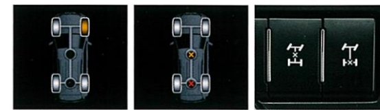
4輪トラクション作動表示例 デフロック作動表示例 センターデフロックスイッチ&リヤデフロックスイッチ(マルチトレインセレクト装着車)
