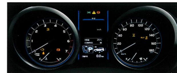
オブティロンメーター(TFTカラーマルチインフォメーションディスプレイ)
