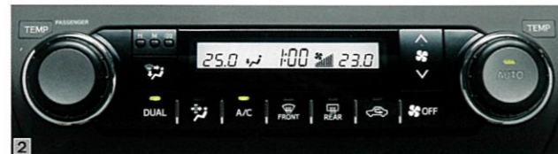
2 ヒーターコントロールパネル
