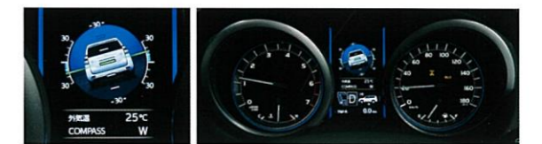
傾斜角モニター表示例
