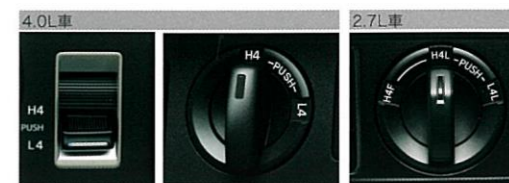
4.0L車 2.7L車 トグル式トランスファー切替スイッチ(マルチトレインセレクト装着車) ダイヤル式トランスファー切替スイッチ ダイヤル式トランスファー切替スイッチ
