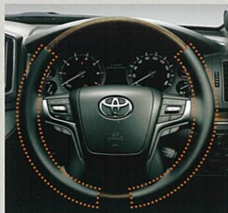
ヒーター加温箇所
