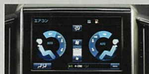
フロントヒーターコントロールパネル (T-Connect SDナビゲーションシステム装着車)
