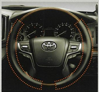
ヒーター加温箇所
