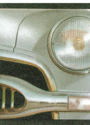
ヘッド・ランプはセミ・シールド式で、電球の寿命長く、反射鏡の光沢もそこなわれません。ランプは2段切換式で操作はペダル下部のデイマー・スイッチで行います
