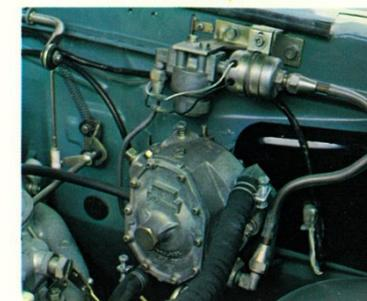
**高性能を生む専用キャブレター**…すばらしい出足・加速。余裕のある馬力…ガソリン車と変わらない高性能を生み出す、ニュークラウン専用のキャブレターです。さらに、LPGを減圧・酸化し、エンジンの負圧に応じ、ガスをキャブレターに導く、LPG専用のレギュレーターを装備。ソレノイドバルブ・ボタン、スロットルボタンは、計器盤にあります。
