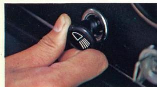
セフティ・スイッチ…弾性がある、つよい力が加わると写真のようにまがります。万一の衝突時にも、固い凸起物による危険をふせぎます。絵表示式で、識別も容易です。
