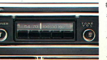
**押しボタン式のHiFiラジオ**…ボタンを押すだけで選局ができます。感度がするどく、ビル街でも安定した音質を保ちます。自動アンテナがつきます。（注文装備品）
