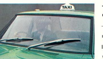
**インスタント・アクションのワイパー**…スイッチ・ONの一瞬に作動します。高速走行中、不意に前窓が汚れた時も瞬時に視界を回復できます。ワイパー速度は2段切かえ式
