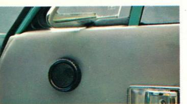
**ドア内側の安全設計**…三角窓のレギュレーターは、平らなダイヤル式。ドア・ハンドルは折り込み式です。凸起部は弾性のある材質が使われ、内張りも、すべてソフトです。
