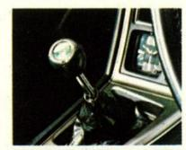
ご好評。豪快な5段フロアシフト。5速目は0.858のオーバートップ。セダンSL、ハードトップ全車に用意。
