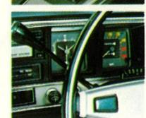
静かな操縦性の3速コラムオートマチック。発進から最高速までアクセルペダルの操作だけでできます。
