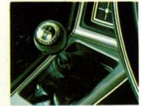
セパレートシートとの組み合わせでスポーティドライブが楽しめる4段フロアシフト。オールシンクロメッシュ機構。
