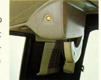
のシートベルト締め忘れを防止するための警告灯を新採用しています。
