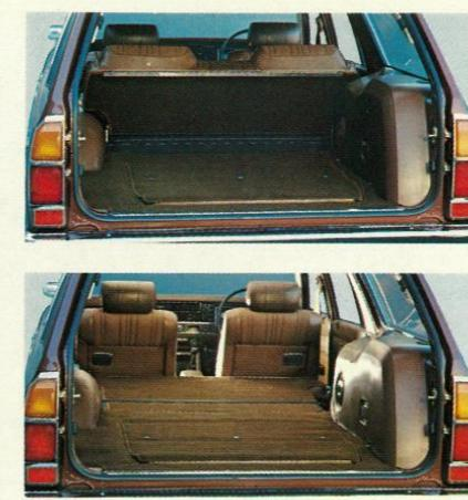
ますます大きく扱いやすくなったりやスペース。量感を増したスタイリングからもおわかりのように、高さも幅も増して、車室後部の容積は15%もアップしました。さらに、はねあげ式のリヤゲートもグンと大きくなり、開口を拡張。荷物の出し入れ、サードシートへの乗り降りも一段と容易です。大きなリヤクォーターウィンドウ、段差を少なくしたりやのデッキフロア、最後部までいきわたる換気システムなど、すみずみまで綿密な配慮を施しました。サードシートを立てれば8人乗り（セパレートシート車は7人乗り）。リヤシートを折り畳めば、広く平らなデッキ。全長2メートル以上、幅1190mmと、シングルベッドくらいならラクラクと収容してしまう大きな荷室になります。
