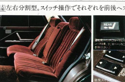
フロントラウンジシート（ハードトップのコラムシフト車、セダン・ロイヤルサルーンGのコラムシフト車に標準装備。セダン・ロイヤルサルーン・スーパー・キーレーンエクストラのコラムシフト車にオプション装備。）
