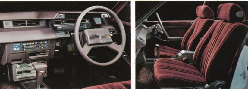
〈主な標準装備〉フルフレーム4輪独立懸架・メモリー付テルト&テレスコピックステアリング(フロアシフト車)・デュアルオートエアコン・オートドライブ・マルチジャヤスタブルパワーシート(運転席)・4輪ベンチレーテッドディスクブレーキ
