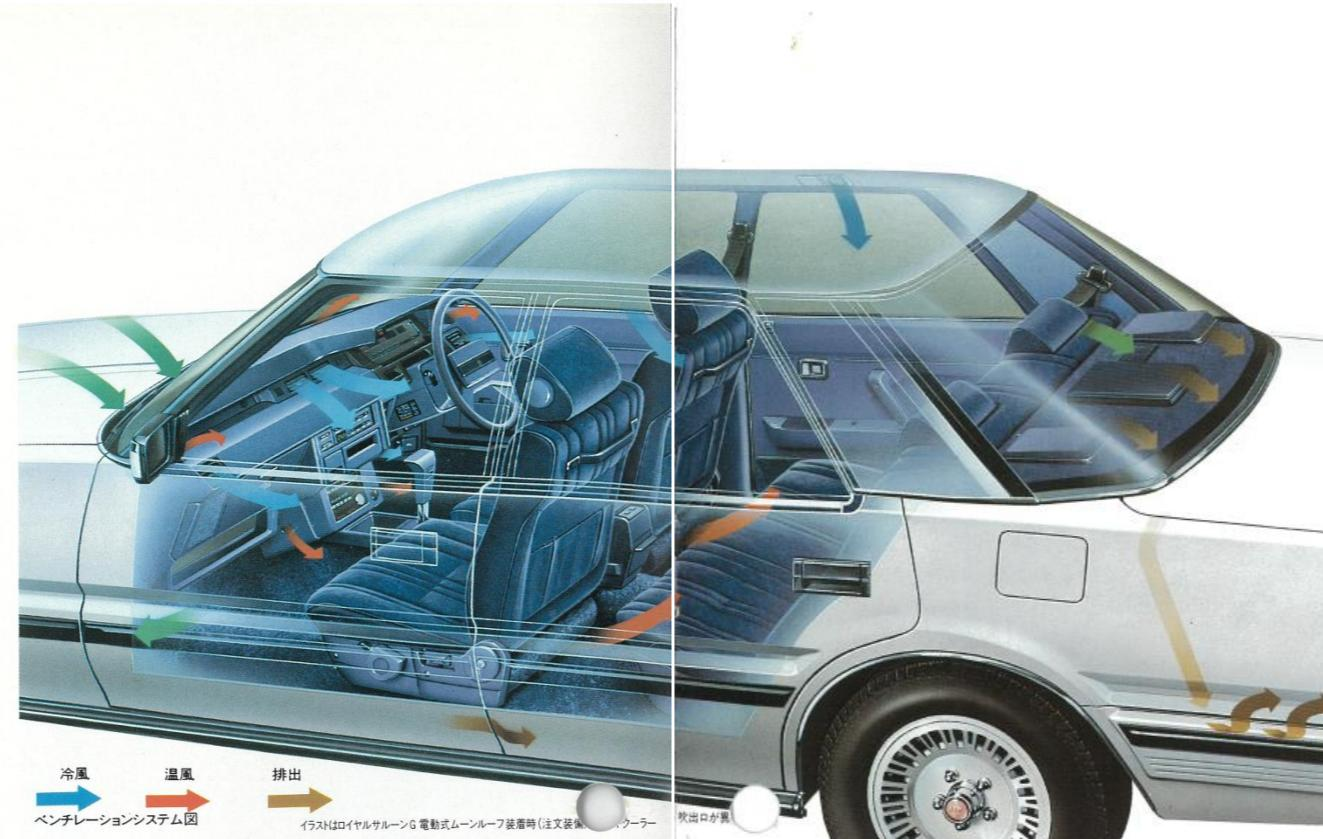
ルーバーが左右に首振式に動いて、風をキャビンの隅々まで届かせるスインググリルを採用。長時間エアコンを使用した際の快適性が一段と向上しています。また世界初の10気筒可変容量エンジンプレッサーの採用(3000ml)によって冷房性能を悪化させることなく燃費を節約することにも成功しています。クラウン室内の快適さを存分にご満喫いただけます。
