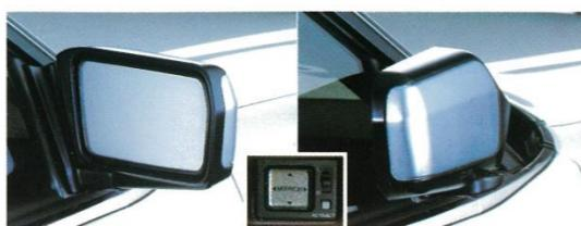
で、手軽にミラーを格納や再セットできます。途中でイグニッションキーを抜いても、ミラーは定位位置まで倒れてから停止。さらには、前方に倒れた状態からでも正常位置に戻る、便利さのゆき届いた新機構です。
