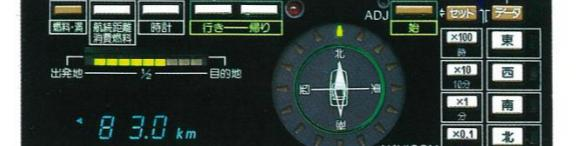
マイコンが、目的地への誘導的確なクルージングのためのさまざまな情報を提供します。目的地の方位、到達度、航続距離、消費燃料などを見やすく表示。合理的でムダのない運転をお約束します。
