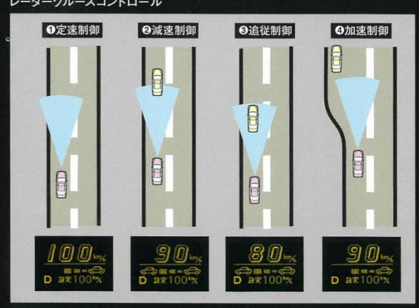
①定速制御 希望の車速(約50~100km/h)をクルーズコントロールスイッチでセットすることにより定速走行を開始。希望の車間距離をステアリング部のスイッチで選択。
