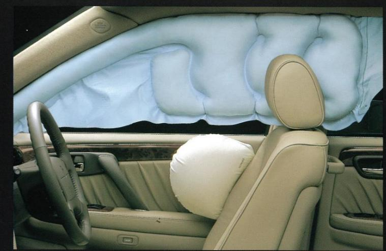
SRSサイドエアバッグ、SRSカーテンシールドエアバッグ
