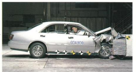
オフセット前面衝突実験(64km/h、写真は実験用試作車です。)
