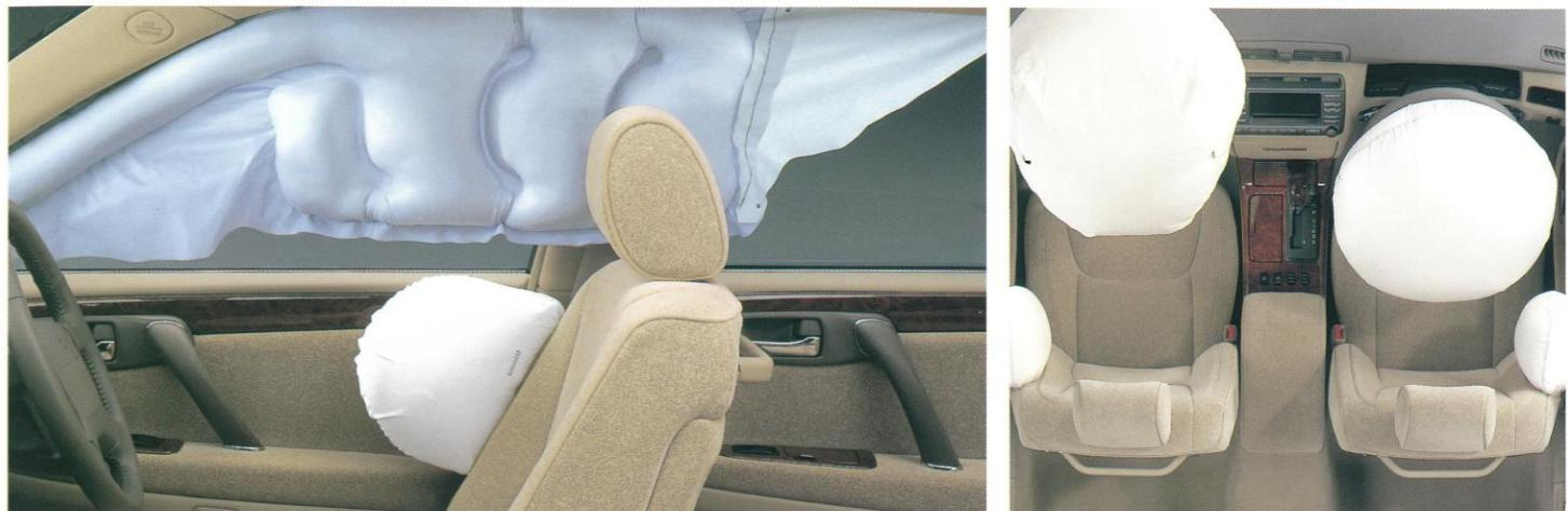
SRSサイドエアバッグ&SRSカーテンシールドエアバッグ(運転席・助手席)
