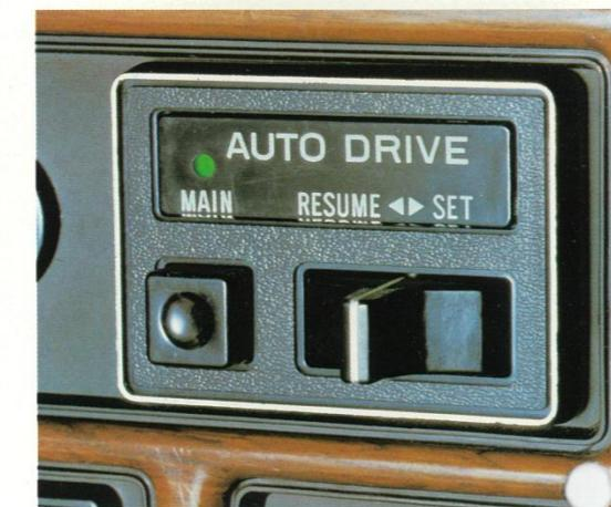
オートドライブ(セダン・EF1スーパー・デラックス以上、ハードトップ系・スーパー・エディション以上に注文装備)④…ご希望の速度になったら、スイッチをセットするだけでそのままの車速を維持します。解除は、ブレーキかクラッチペダルを踏むだけ。
