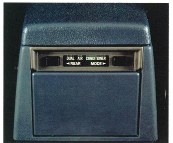
後席クーラーコントロール(ロイヤル・サルーン)⑮…後席専用クーラーのために、後席にもコントロールパネルをセット。後席からも、自由にクーラーを調整いただけます。
