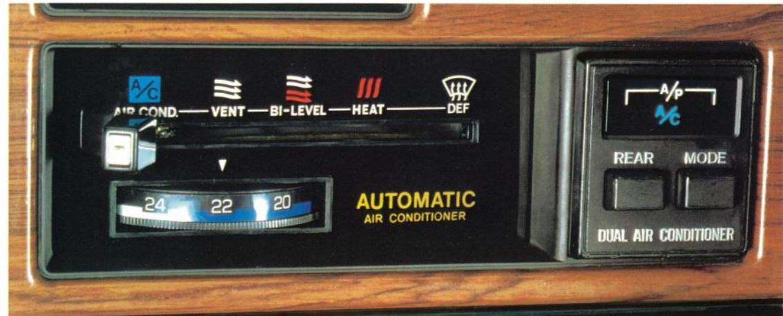
オートデュアル・エアコン(ロイヤル・サルーン)⑭…お好みの温度にセットしておくと、内外気センサーが温度、日射を感じ、自動的にその温度に保ちます。さらに、ご希望の温度になるまであいだ、人間の感覚に合わせてキメ細かく制御する機構も内蔵。プロアの音も静かで、室内は快適そのものです。そのうえ、コントロール部に夜間照明を設けて、夜間の操作をラクにしました。
