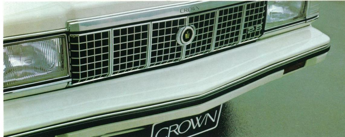
衝撃吸収式カラード・ウレタンバンパー(2800車)…フロントに、リヤに、大きく突き出したクラウン専用のウレタンバンパー。軽い衝撃を内部のウレタンフォームがやわらかく吸収して、ボデーへの傷つきを防ぎます。また、ボデーカラーとカラーコーディネートさせて、クラウンならではの端正なスタイリングをいつそう引き締めるとともに、高級感あふれる走りを演出してくれます。
