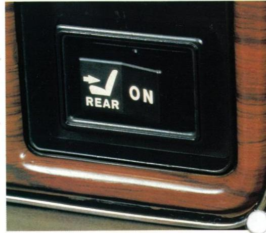
**リヤパワーシート/運転席スイッチ**…運転席の計器盤上に解除スイッチをセットしました。ONにすると、前方にスライドした後席シートがスムーズに位置に戻る便利な機構。
