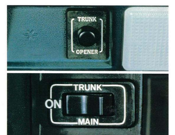
電磁式トランクオープナー(セダン・デラックスA以上)…運転席からトランクが開けられる便利な機構。メインスイッチは、マスターキーでしか開かないグローブボックスの中に設置しています。
