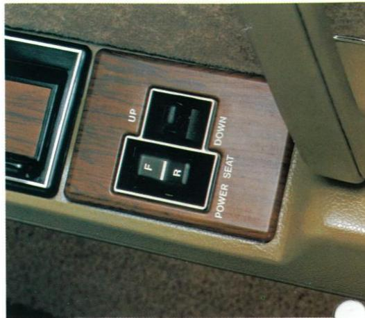
**リヤパワーシート/後席スイッチ**…後席アームレスト上にセットしました。Fスイッチを押すと前へ移動し、Rスイッチを押すと後へ、シートがスライドする便利で快適な機構です。
