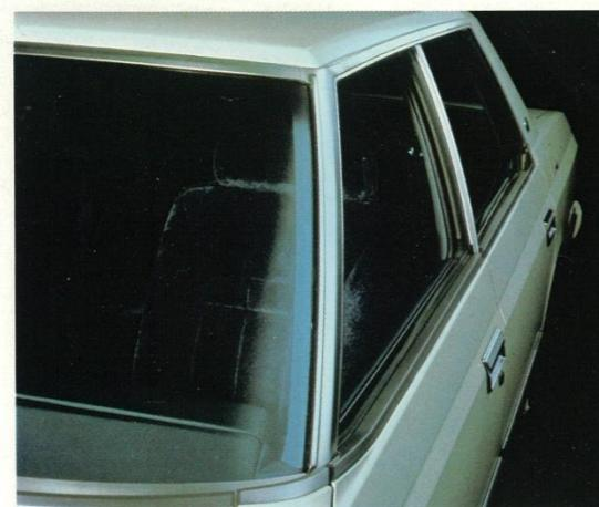
水切り機構付フロントピラーモール…広い前方視界を確保し、風切音も低減。また、ピラーとフロントウインドウの間に雨どいを設け、サイドウインドウへの雨の流れを少なくします。
