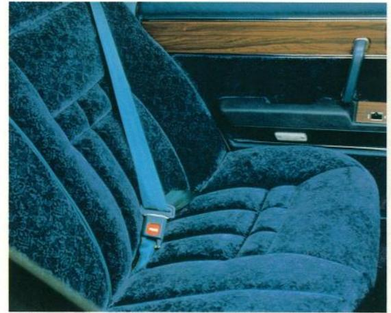
連続ウェビング式リヤ3点式ELRシートベルト(セダンヒード・ハードトッップ)(ロイヤル・サルーン)⑪
