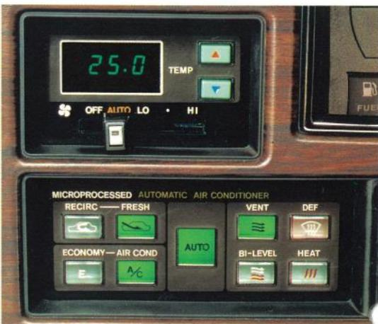
マイコンオートエアコン(ロイヤル・サルーン)…フェザータッチのボタンスイッチ、ON・OFF点灯表示、デジタル温度表示を採用。また、後席コントロールで後席からも温度調節ができます。
