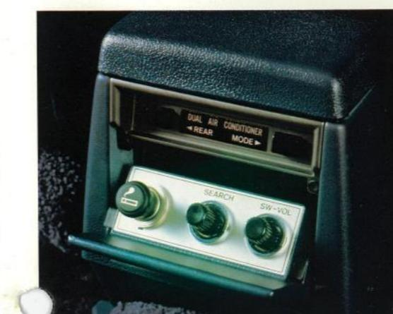
**後席ラジオコントロール装置(スーパーサルーン以上)②**…ON/OFF、音量調整、選局、およびカセットテープのプログラムを後席からも容易に操作。後席の方の便を考えた装置です。
