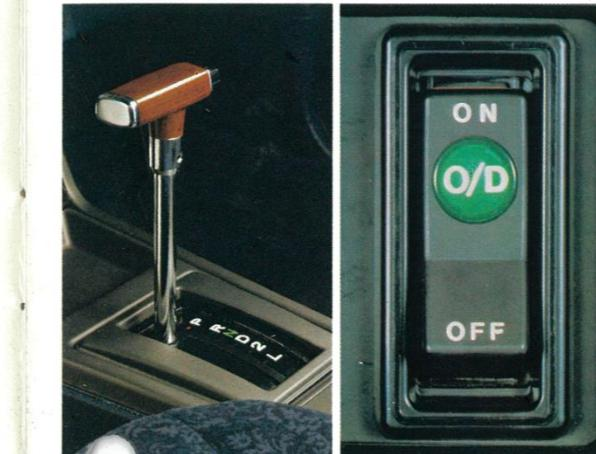
オーバードライブ付4速オートマチック(M-Uエンジン車とJエンジン車)①…4速目にオーバードライブを設定。計器盤上のスイッチをONにしておけば自動的に4速まで入る画期的な機構です。
