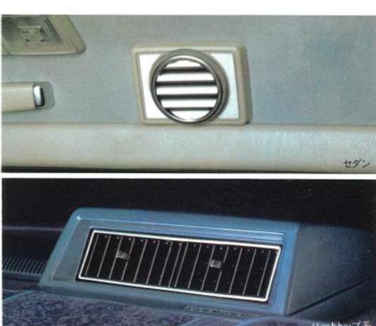
後席専用クーラー吹出口(ロイヤル・サルーン)…セダンは後席ドア寄りの天井横に、ハードトッップ系はリヤパッケージトレイにセット(⑰)。風向きは、グリルで容易に調整できます。
