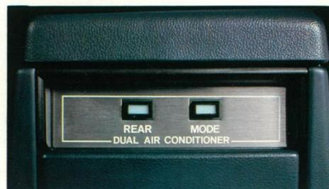
**後席クーラーコントロール** (ハードトップ系・セグメント) ⑥ 後席専用クーラーは、前席だけでなく後席からも操作できます。クーラー、エアピュリファイヤーのON・OFF、風量調節も自在です。
