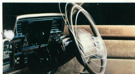
**チルトステアリング** (ハードトップ系・セグメント) ⑪ 簡単な操作でステアリングの高さを6段階に調節できます。コラムオートマチック車にも新採用。正しい姿勢で快適な運転をどうぞ。
