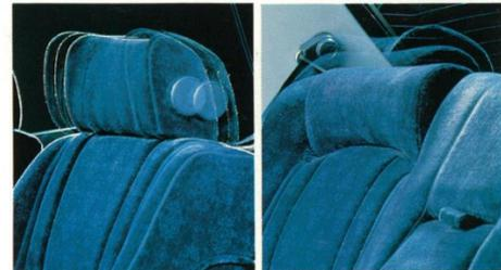
前後調整式フロントヘッドレスト(ハードトップ系スーパーエディション以上)⑬前後・上下に調節でき、最適な姿勢をとれます。リヤヘッドレストも回転式(4ドアハードトップ・セダンはスーパーサルーン)で、お好みの位置で使えます。
