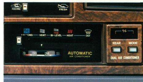
**デュアルオートエアコン** (4ドアハードトップ・セダン/セグメント) ⑥ ダイヤルでセットした希望室温をコンピュータ制御で維持。セット温度になるまで人間の感覚に合わせて制御する機能も採用した快適設計です。
