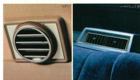
**後席専用クーラー吹出口** (ハードトップ系・セグメント) ⑥ 冷風が爽やかに後席に広がります。セダンは後席ドア寄りの天井に、ハードトップ系はリアパッケージトレイに (ハードトップ系)。風向きも自由に変えられます。
