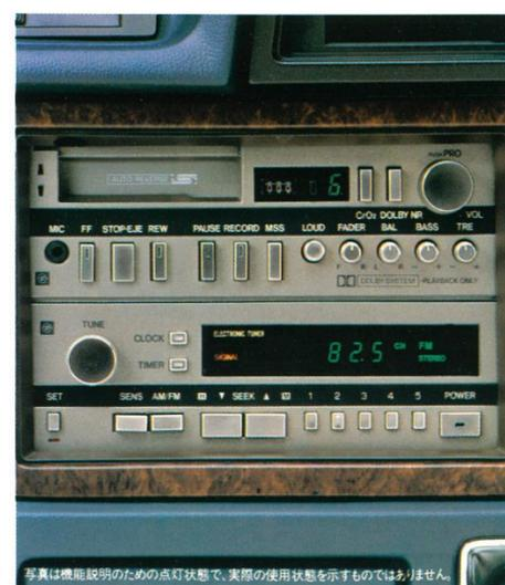
**番組予約付電子チューナーラジオ+録音機構付ソフトローディングカセットステレオ** (ハードトップ系・セグメント) ⑭ 好評の番組予約機能に加え、ソフトチューニング回路など新機構を盛り込んだ新型ラジオ。スピーカー性能も向上し、クリアな音質です。カセットステレオもマイコン制御。テープを自動的に引き込むソフトローディング機構や自動選曲機構も新採用。メタル対応、ドルビー回路 (ドルビーII型) 付です (再生のみ)。
