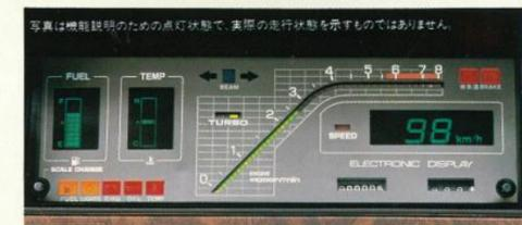
大胆な表情の内に確かな機能を秘めた先進のインストルメントパネル。デジタル式スピードメーターは、昼夜見やすい蛍光表示管式。刻々と変化する車速を無理なく読める時間間隔で表示します。ターボパワーの高まりを告げるタコメーターは、発光ダイオード式。ターボ作動状態には表示ランプも点灯します。ゾーン表示式燃料計は通常の表示に加え、残量15~5ℓではスイッチ操作で約1ℓずつ残量を知らせる設計です。(ハイパーターボ系ターボエンジン参照)
