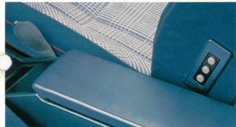
エア式ランバーサポート(2ドアハードトップ・ロイヤルサルーン)⑦シートバック内蔵のエアバックに空気を充たして腰部に圧力を与え、疲れを軽減。空気の充填はエアポンプ、減圧はバルブスイッチで行ないます。
