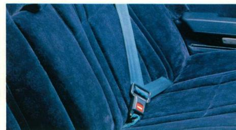
**3点式ELRシートベルト** ⑬ 装着しやすく、束縛感の少ないELRタイプを後席にも採用 (ハードトップ系・セグメント以上)。運転席は、より快適なテンションリデューサー付 (ハードトップ系・セグメント以上、セグメント以上)。
