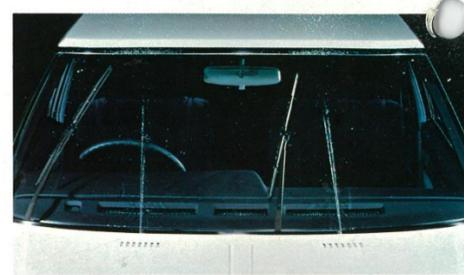
ワイパーアーム同期ウォッシャー④ワイパーアームにシンクロして、洗浄液を断続的に噴射。少ない量でムダなく洗浄できるため、洗浄液を補給する間隔がさらに延びました。
