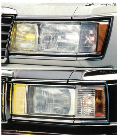
ハロゲンヘッドランプ&フォグランプ(ハードトップ系)濃い霧でも強力に前方を照らし出すフォグランプをハードトップはスポーティに、セダンは格調高く配置。いずれも空気抵抗減少のために、ボデー面と一体化した機能美あふれるデザインです。明るい白色光を長期間維持するハロゲンランプは、バルブの交換が簡単に行なえるセミシールド型。ランプ消し忘れ防止機構(スーパーサルーン)もクラウンならではの装備です。
