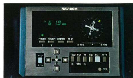
ナビコン(ハードトップ系・ロイヤルサルーン5M・GEU車に注文装備)③マイコンが目的地へ誘導する画期的機構。あらかじめ距離と方向をセットして出発すれば、目的地の方位と到達度を示します。
