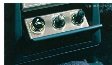
**後席ラジオコントロール** (ハードトップ系・セグメント) ⑭ ラジオのON/OFF、音量調節、選局、カセットテープのプログラム変更が後席から自在です。 (選局機能は電子チューナーラジオ+マルチサーチラジオに、プログラム変更機能はそれぞれの専用カセットにのみ搭載)。
