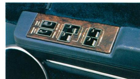
**電磁式オートドアロック** (ハードトップ系・セグメント) ⑭ / **ワンタッチパワーウィンドウ** (ハードトップ系・セグメント) ⑭ 手動のはか20km/hでドアが自動ロック。ワンタッチで運転席窓が全開・閉。運転席わきに機能を集中。
