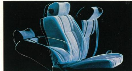
アジャスターメモリー付シートリクライニング(2ドアハードトップの運転席)⑩シートバックがセットされた角度を記憶。後席への乗り降りなどで前後へ倒しても、引き起こせば元の位置に戻ります。
