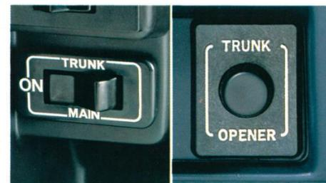
**電磁式トランクオープナー** (ハードトップ系・セグメント) ⑭ 運転席からボタン操作でトランクを開けられます。マスターキーでしか開かないグローブボックス内にメインスイッチがある安全設計。
