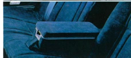
**電話機取付対応** (ハードトップ系・セグメント) ⑬ 第一線で活躍される多忙な方がたに人気の自動車電話。年々、拡充されるサービス網とともに、その利用率も高まっています。時代を見つめて、クラウンは他に先駆けて電話機の取付に対応。後席のセンターアームレストは、引き出して蓋を開けると内部に電話機を格納できる構造。室内スペースを有効に利用し、室内をスッキリと見せるVIPのための入念設計です。
