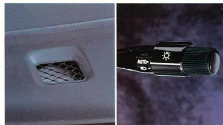
コンライト(スーパーサルーン)②車外の明るさの変化をセンサーが感知して、自動的に車幅灯、ヘッドランプ、テールランプを点灯/消灯。ライティングスイッチ「AUTO」で作動します。
