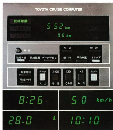
クルーズ・コンピュータ(ハイブリッド系・ロイヤルサルーン5M・GEU車に注文装備)①高性能、マイクロコンピュータが、あらかじめインプットされたデータと走行状態をチェック。便利なドライブ情報を提供します。一番上の写真は残り燃料であとどれだけ走れるかを示した「航続可能距離」。そのほか「到着予想時刻」、「平均車速」、「消費燃料」、「時間」など10項目を表示します。操作性をいちだんと向上した新タイプ。合理的で、ムダのない運転をお約束します。
