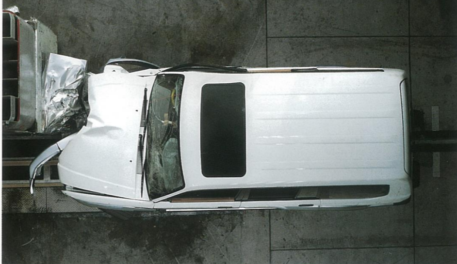
オフセット前面衝突実験(60km/h) (写真は実験用の試作車です。)
