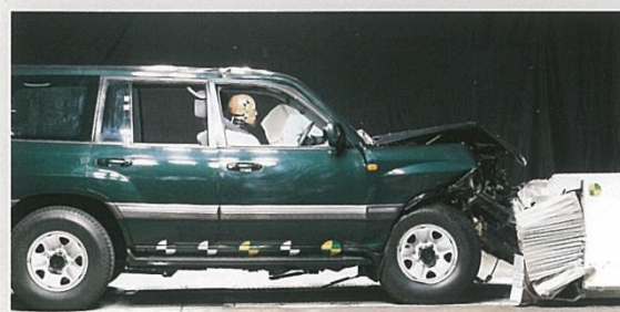
●オフセット前面衝突実験 (60km/h) ■写真は実験用の試作車です。
