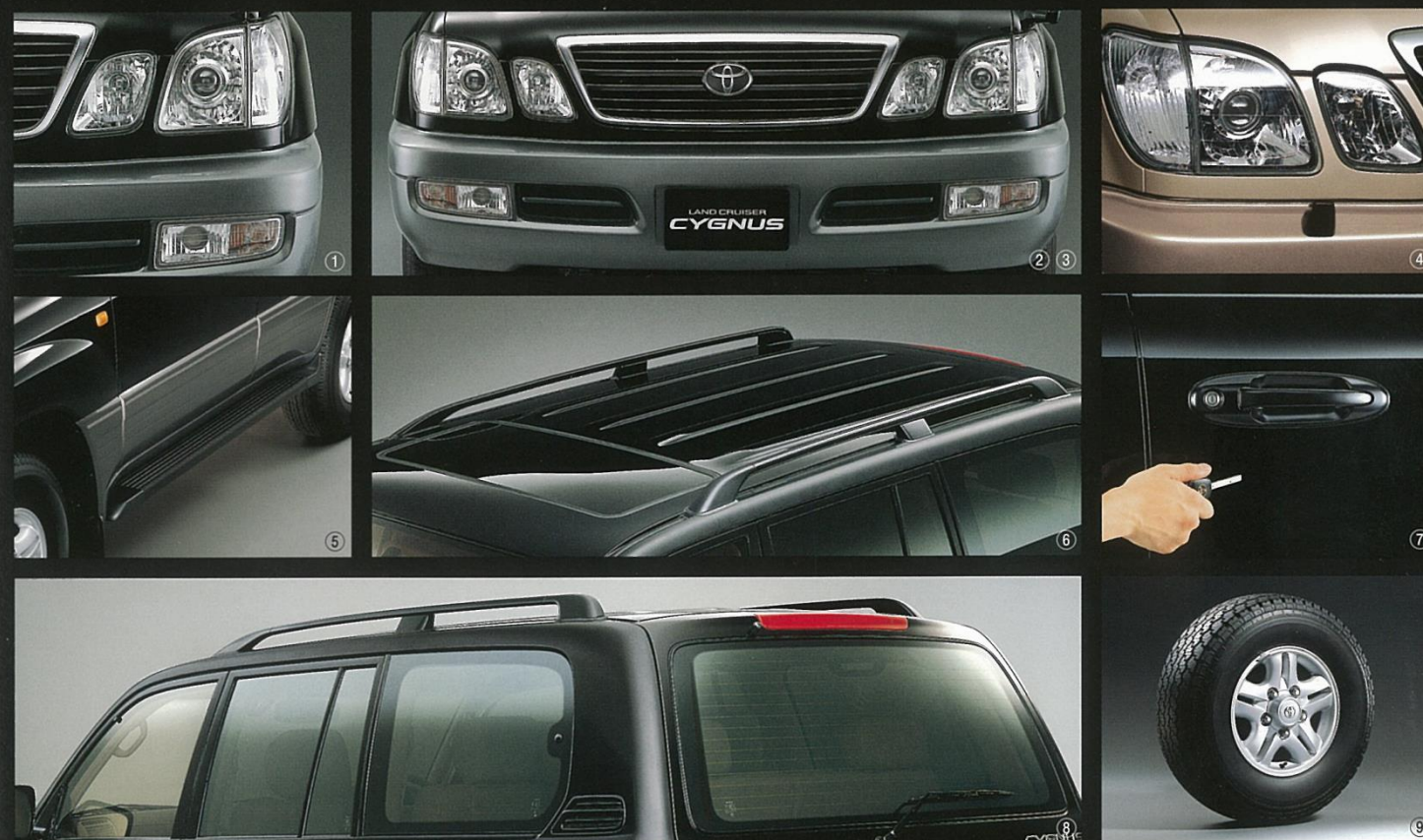
EXTERIOR ①プロジェクター式ヘッドランプ（ロービーム）&フォグランプ ②専用フロントグリル ③専用フロントバンパー ④ヘッドランプクリーナー（メーカーオプション） ⑤すべり止め付サイドステップ ⑥ルーフレール ⑦ワイヤレスドアロックリモートコントロール ⑧プライバシーガラス（リヤドアガラス、リヤクォーターガラス、バックドアガラス） ⑨275/70R16ラジアルタイヤ&専用16×8Jアルミホイール
