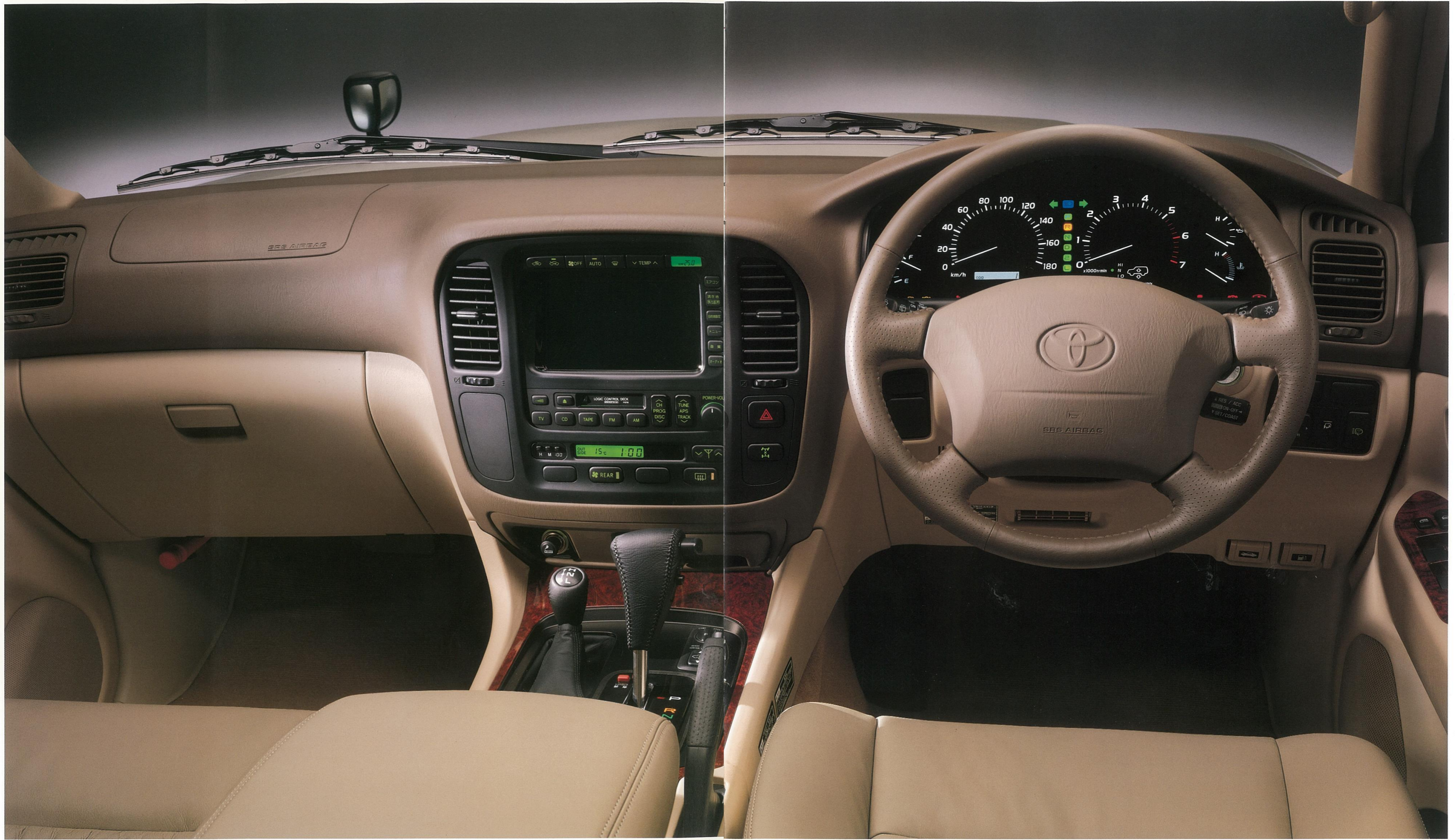
Photo:ワゴンVXリミテッド“Gセレクション”。内装色はオーク<40>。本革シート、パワーシート(運転席・助手席)、シートヒーター(運転席・助手席)、電動チルト&テレスコピックステアリング、革巻リヤコンソールボックスはセットでメーカーオプション。 GPSボイスナビゲーション付EMV(エレクトロマルナビジョン)、ランドクルーザー・スーパーライブサウンドシステム(EMV仕様)、マルチCDオートチェンジャー、TV/FMダイバシティガラスアンテナはセットでメーカーオプション。 ■写真のオプティロンメーター等は機能説明のために各ランプを点灯させたものです。実際の走行状態を示すものではありません。■写真は説明のためにボディの一部を切断したカットモデルです。
