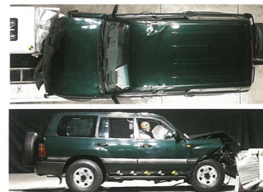
オフセット前面衝突実験(60km/h。写真は実験用の試作車です。)
