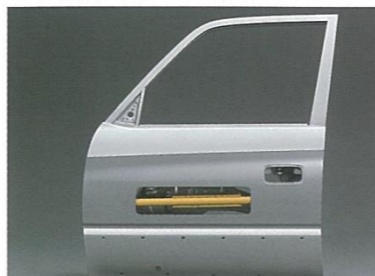
●サイドアビーム (写真は機能説明のために着色したものです。)
