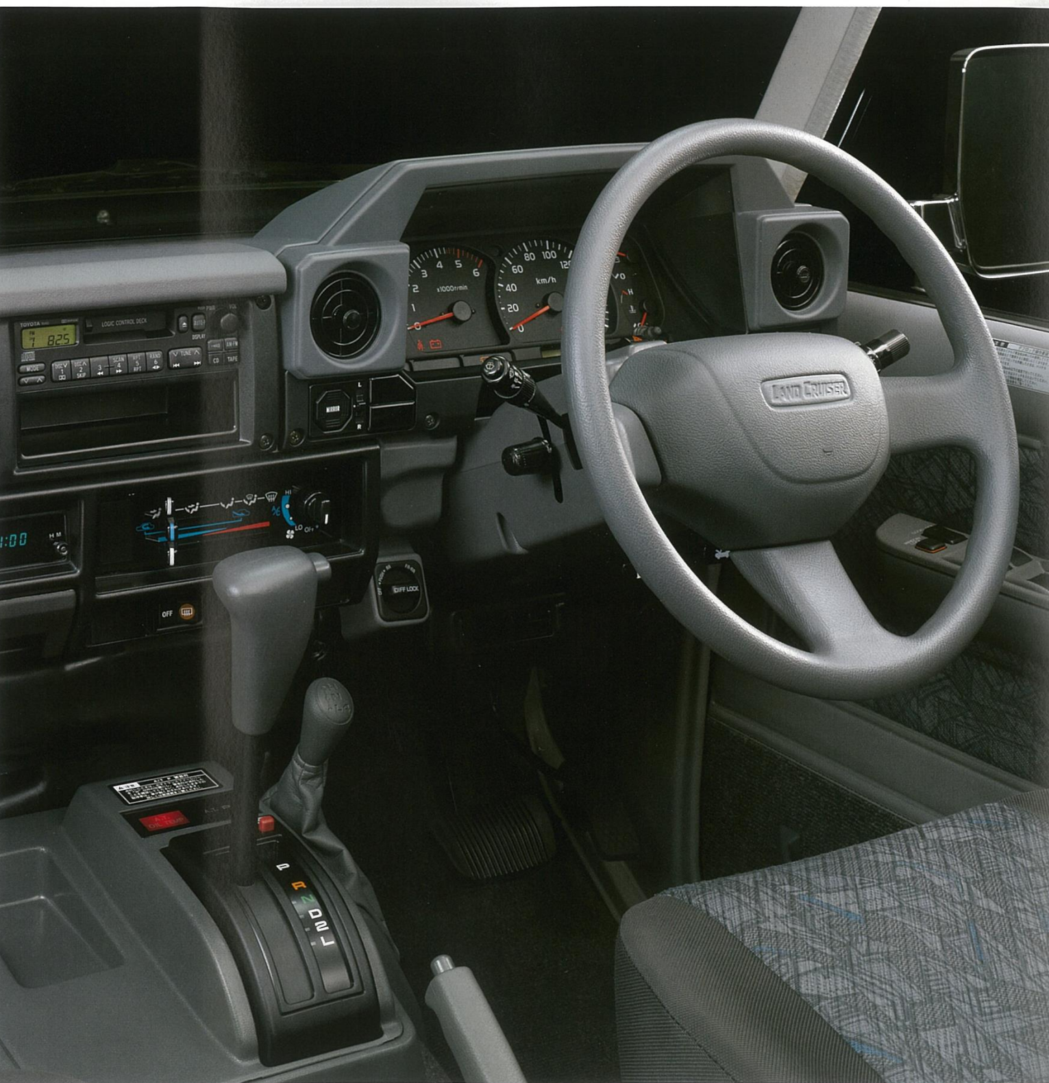
Photo:ZX 4ドア・電子制御式4速オートマチック(ECT)。内装色はグレー<10>。電動デフロック(フロント&リヤ)はメーカーオプション。リヤヒーターは寒冷地仕様とセットでメーカーオプション。 *写真は機能説明のために計器盤の各ランプを点灯したものです。実際の走行状態を示すものではありません。
