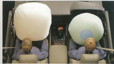
●オフセット前面衝突実験 (60km/h) ■写真は実験用の試作車で。
