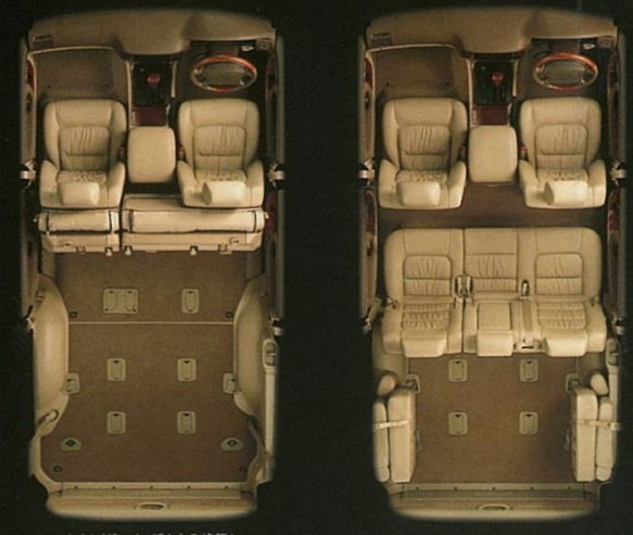
セカンドシート、折たたみ状態&ディタッチャブルサードシート取り外し状態 サードシートスペースアップ状態
