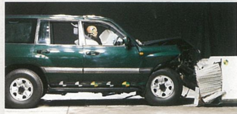
●オフセット前面衝突実験 (60km/h) ■写真は実験用の試作車で。
