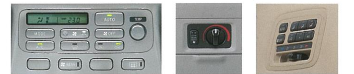
デジタルプッシュ式ヒーターコントロールパネル ※EMV非装着時(ワゴン) リヤヒータースイッチ (VX、パン) デュアルエアコンスイッチ (VXを除くワゴン)
