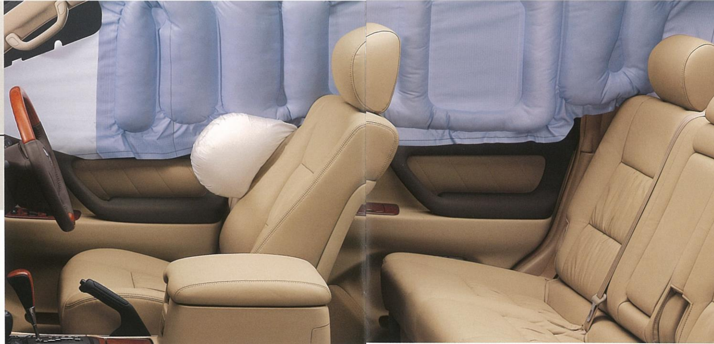
SRSサイドエアバッグ（運転席・助手席）/SRSカーテンシールドエアバッグ
