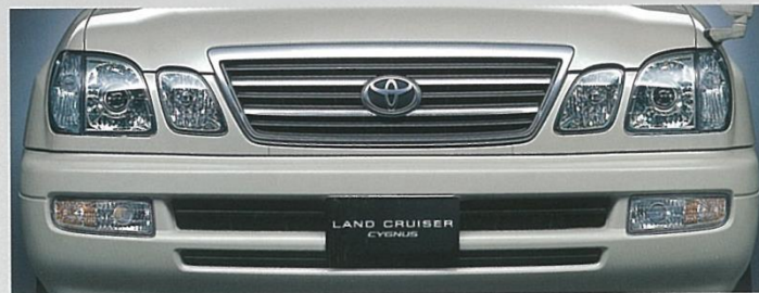
専用フロントグリル/専用フロントバンパー/プロジェクター式ヘッドランプ (ロービーム) & フォグランプ
