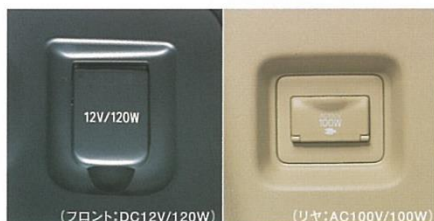
アクセサリソケット (フロント:DC12V/120W) (リア:AC100V/100W)
