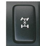
電動センターデフロックスイッチ <VSC・アクティブTRCシステム付車>
